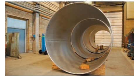
Mantelrör som har valsats från plåt och svetsats till rör för vidare svetsning/tillverkning till ”converters” för ammoniakproduktion.
