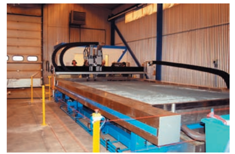
Storleken på skärbordet är 3200x6700mm med en effektiv skäryta på 3010x6100mm. Skärning sker manuellt eller direkt från CAD/CAM-ritningar.
